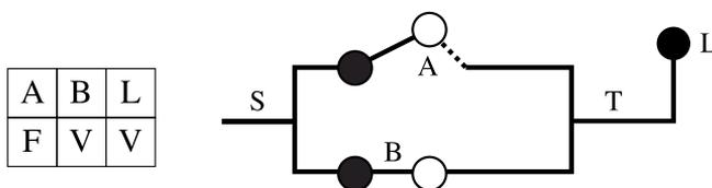
Figura 1.11. Circuito en paralelo con  $A$  abierto y  $B$  cerrado
