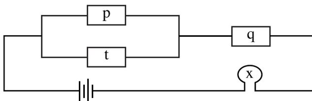
Figura 1.14. Reducción del circuito representado en la figura 1.15
