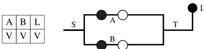
Figura 1.9. Circuito en paralelo con  $A$  y  $B$  cerrados.
