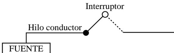
Figura 1.1. Composición de un circuito
