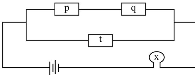
Figura 1.16. Reducción del circuito representado en la figura 1.15.
