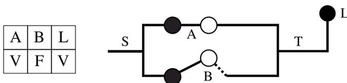
Figura 1.10. Circuito en paralelo, con  $A$  cerrado y  $B$  abierto
