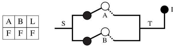
Figura 1.12. Circuito en paralelo con  $A$  y  $B$  abiertos
